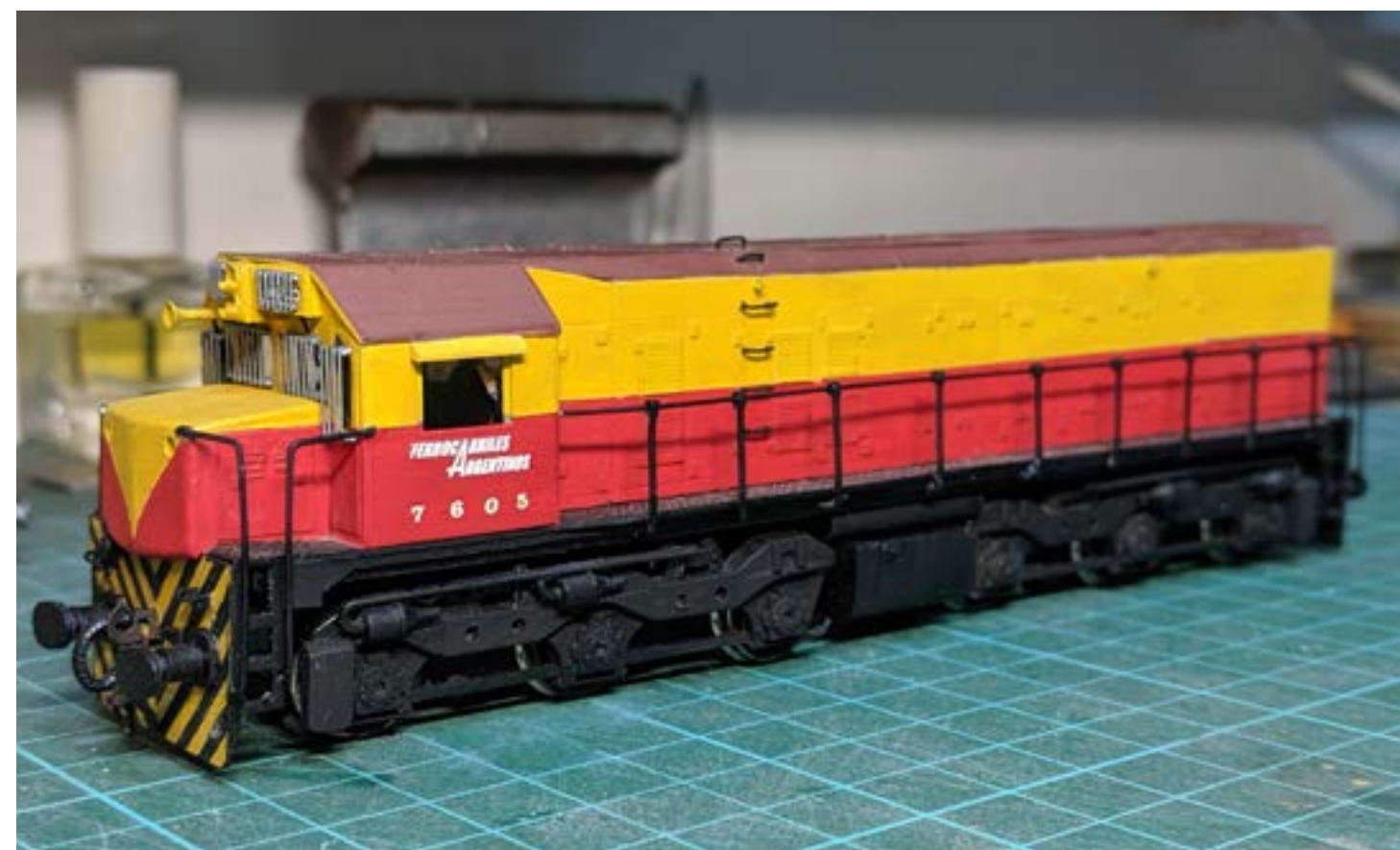
Una G22 del Urquiza hecha minuciosamente pieza a pieza, motorizada con bogies motores Hanazono.
