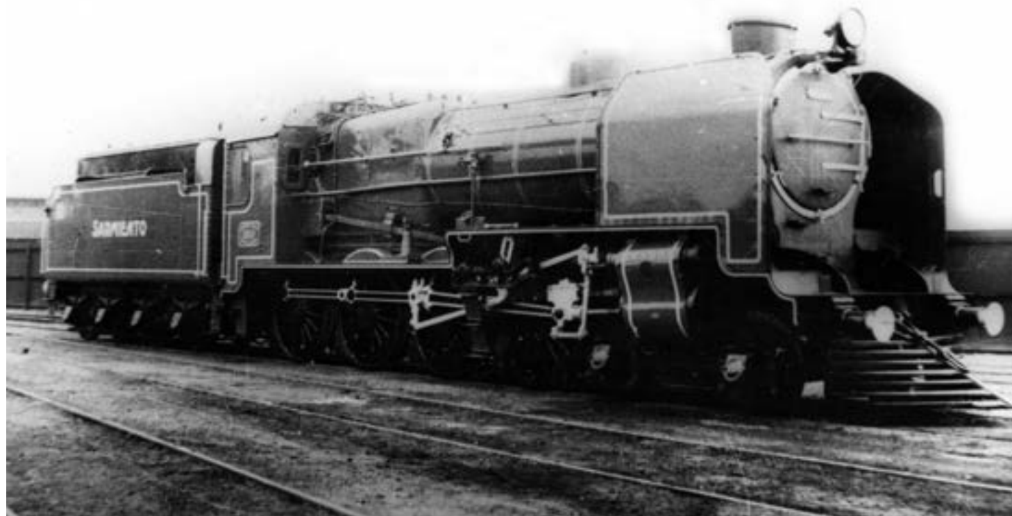
Las Clase 15 fueron reacondicionadas por el FC Sarmiento, Véase los parahumos, el techo de la casilla y la chimenea.
