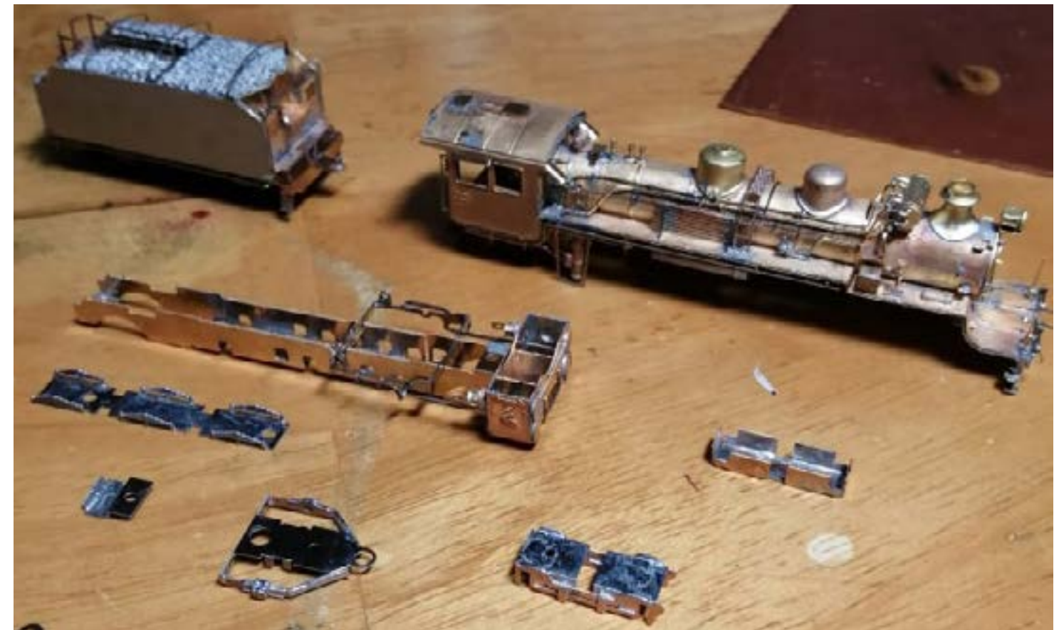
Una vez armado y probado hay que desarmar el modelo para pintarlo.
