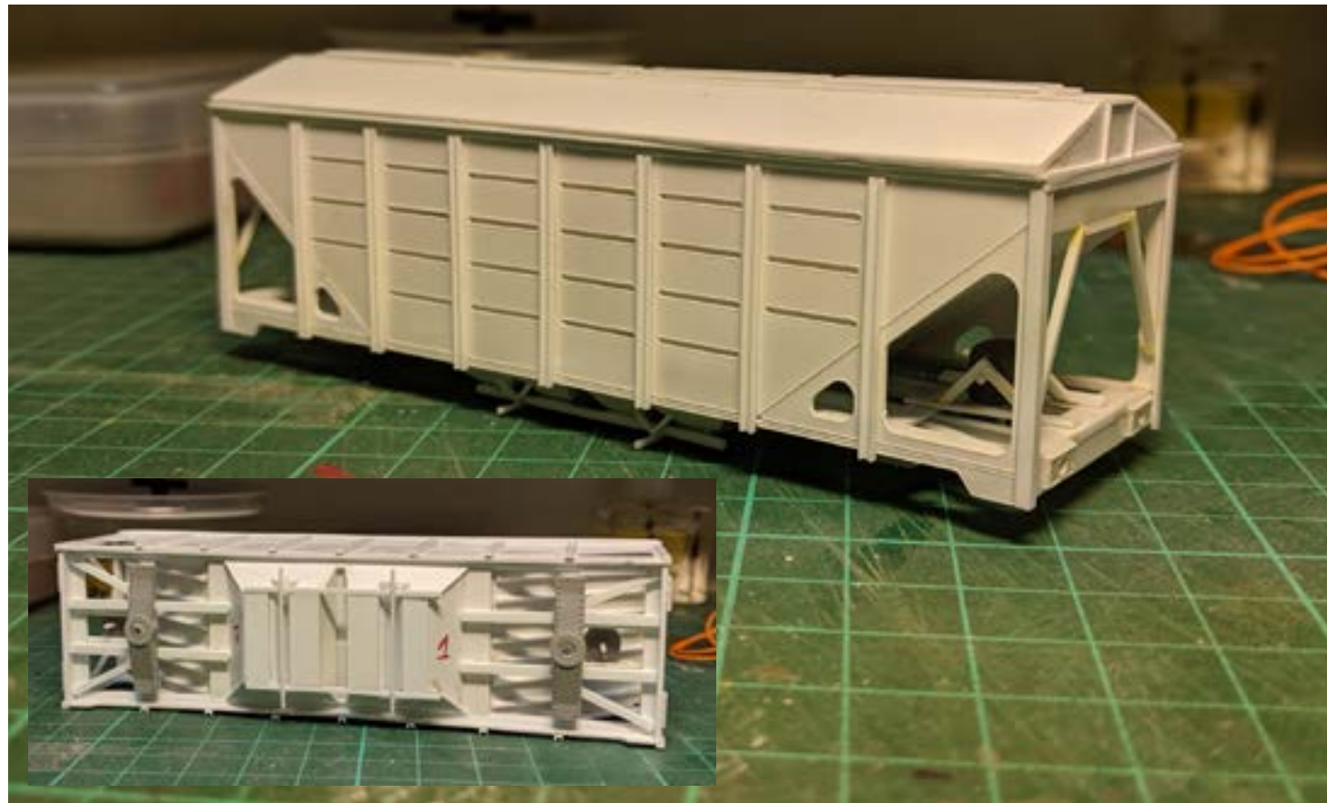
Tolva cubierta en construcción avanzada. Recuadro: Vista inferior donde se aprecian las bocas de descarga.
