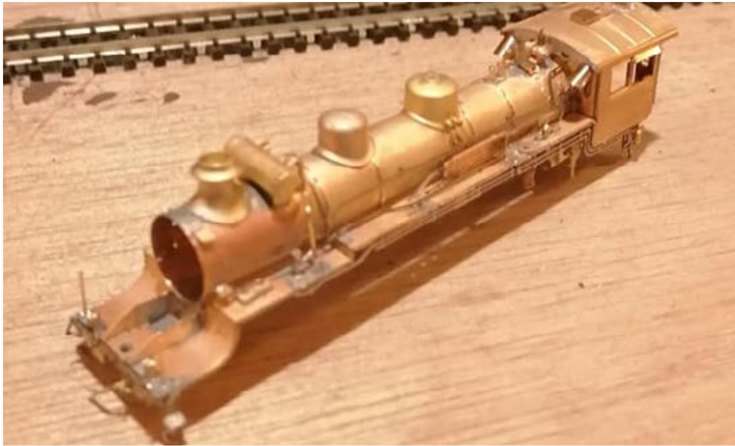
Proceso de armado de la caldera donde se observan las soldadura de estaño.
