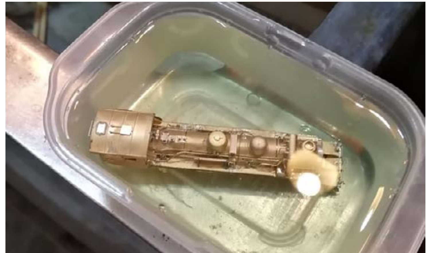
Un baño desengrasante es necesario para que la pintura se agarre bien.
