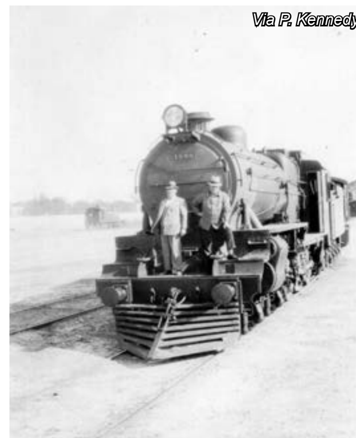
Frente original y frente modificado: Arriba: Clase 15 del FCO, Abajo: Clase 15A del FC Sud.
